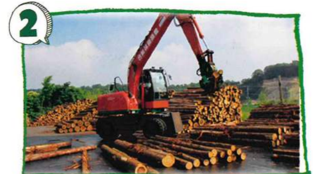
↑トラックが集荷した木材を、所有者毎に置き樹種、長さ、向きをログローダで仕分けします。
