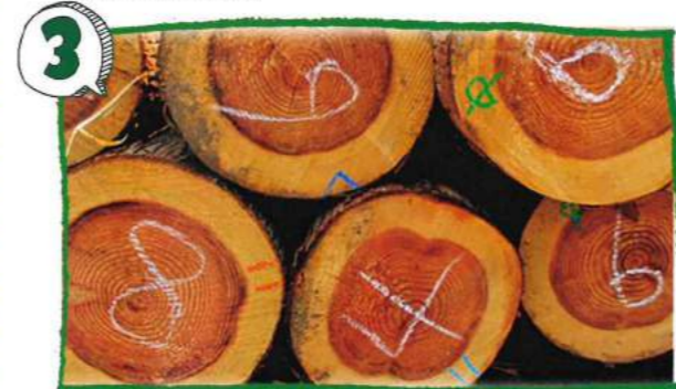
↑ログローダで木材を仕分けした後、所有者の色記号を記入し、大きさを測ります。
