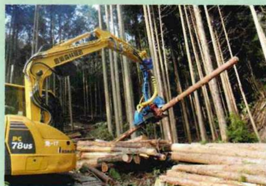
※ハーベスタとは ハーベスタとは1台で伐倒、枝払い、玉切作業を行う多種機能を備えた林業機械です。現在では、間伐や特に主伐の現場においてはハーベスタでの作業が主流となっています。
