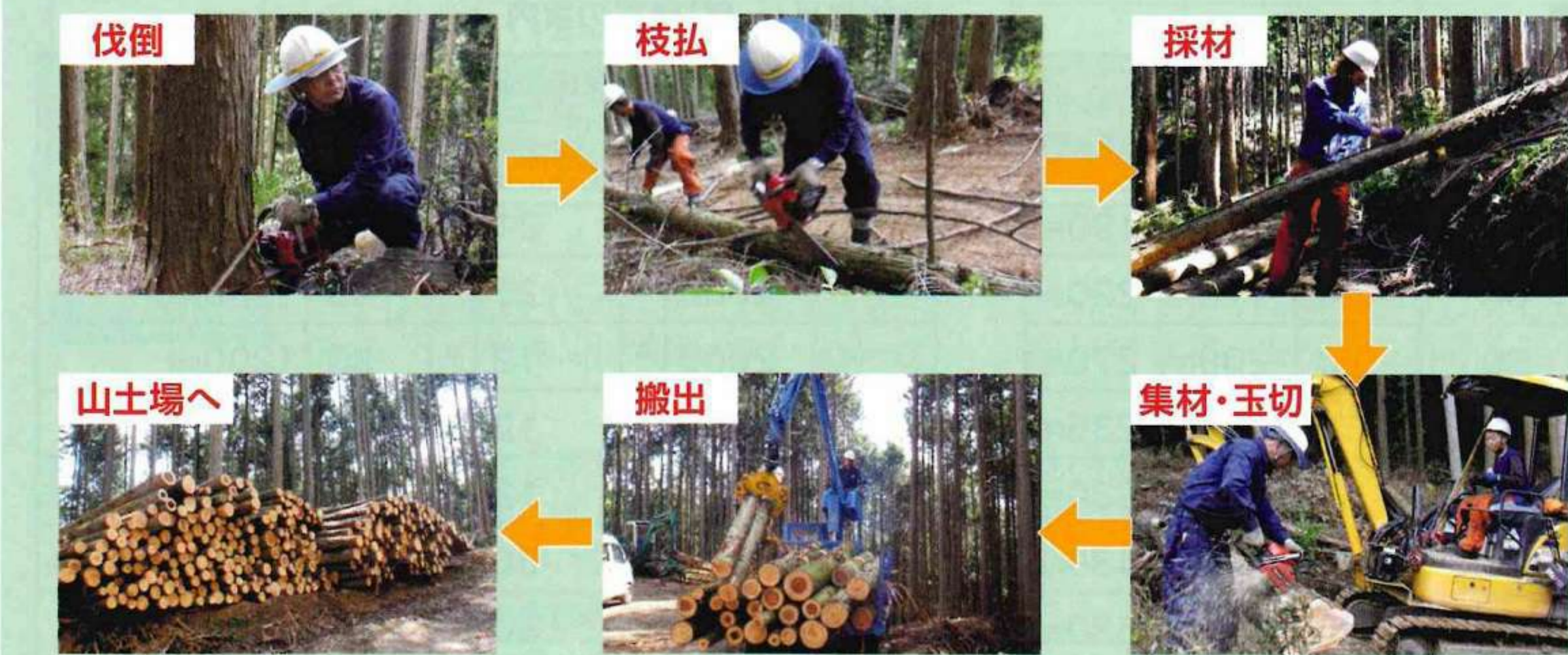
※ハーベスタとは ハーベスタとは1台で伐倒、枝払い、玉切作業を行う多種機能を備えた林業機械です。現在では、間伐や特に主伐の現場においてはハーベスタでの作業が主流となっています。
