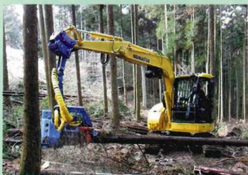
※ハーベスタとは ハーベスタとは1台で伐倒、枝払い、玉切作業を行う多種機能を備えた林業機械です。現在では、間伐や特に主伐の現場においてはハーベスタでの作業が主流となっています。
